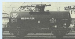
か性ソーダを積み出す専用鉄道タンク車を3台導入し、私有貨車として活用(1948)
